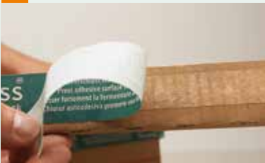
Silikonband vom Selbstklebeverschluss lösen
