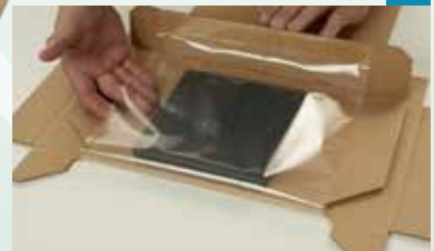
Packgut unter der Folie platzieren
