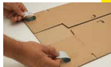
Silikonabdeckband an der vorderen Lasche abziehen
