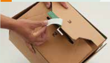
Bodenlaschen nach innen, Verschlusslaschen mit progress-Selbstklebeverschluss verkleben
